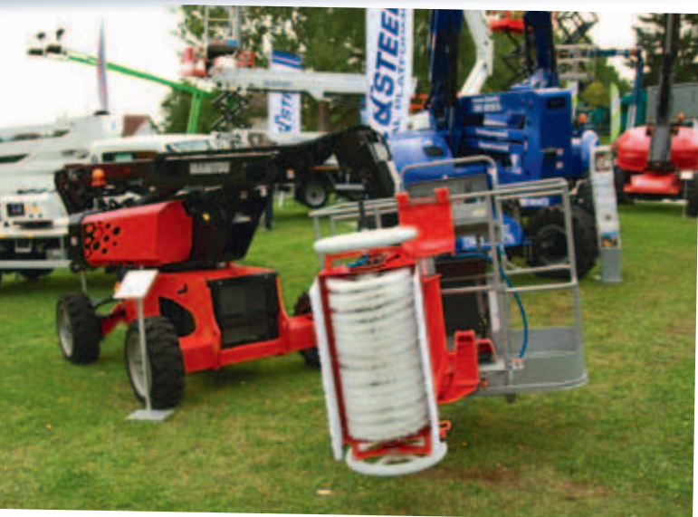
Man'Go 12 mit Hycleaner-Aufsatz zur Fassadenreinigung
