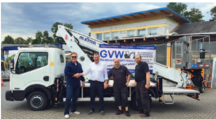
Der Baumaschinen- und Arbeitsbühnenvermieter Geräteverleih Wetterau, kurz GVW, ergänzt seinen Mietpark um eine Scorpion 2313 des italienischen Herstellers. Die LKW-Bühne bietet 22,6 Meter Arbeitshöhe und maximal 12,5 Meter Reichweite auf einem 3,5-Tonnen-Chassis. <<
