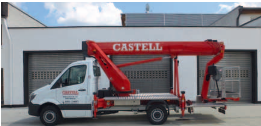
Castell Arbeitsbühnen verfügt mit der neuen TBR 250 von Ruthmann über eine weitere 3,5-Tonnen-LKW-Bühne. Neben einer Arbeitshöhe von 24,5 Metern bietet die Maschine eine Reichweite von 16,5 Meter bei 100 Kilogramm Korblast. „Die Nachfrage nach LKW-Bühnen mit Rüssel in der 3,5-Tonnen-Klasse wird immer häufiger“, erklärt Timo Castell, einer der beiden Geschäftsführer des Vermietunternehmens. <<
