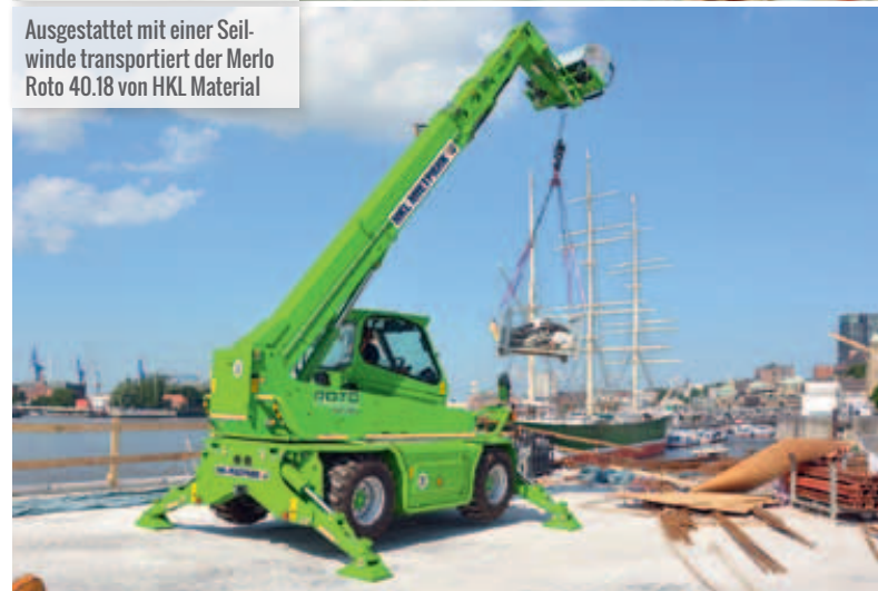
Drehbarer Oberwagen und eine Hubhöhe von 17,70 Metern
