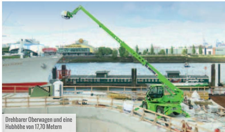
Drehbarer Oberwagen und eine Hubhöhe von 17,70 Metern
