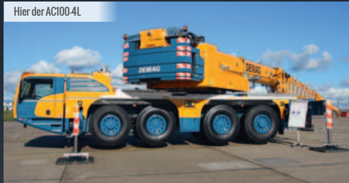
Mit 69,5 Metern bietet der AC 100-4L eine der größten Systemlängen auf vier Achsen bei Einhaltung von 12 Tonnen Achslast
