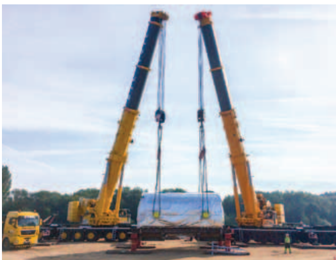
Steil Kranarbeiten aus Trier hat einen neuen Liebherr LTM 1500-8.1 übernommen. Bei seinem ersten Einsatz hob der 500-Tonner mit einem weiteren LTM 1500 im Tandemhub eine 185-Tonnen schwere Gasturbine in Luxemburg. <<
