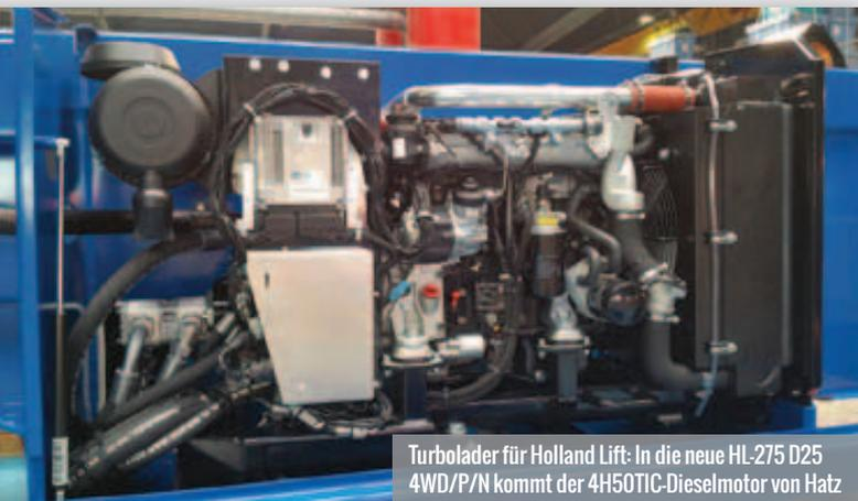
Turbolader für Holland Lift: In die neue HL-275 D25 4WD/P/N kommt der 4H50TIC-Dieselmotor von Hatz
