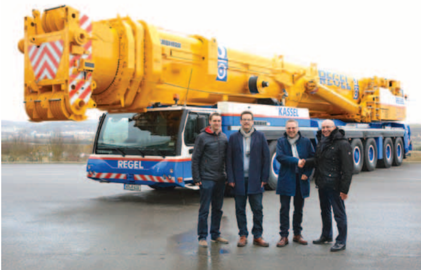
Die Firma Albert Regel aus Baunatal betreibt bereits zwei Liebherr LTM 1500-8.1. Der ältere der beiden wird nun durch einen neuen ersetzt. Im Vergleich zu dem 14 Jahre alten Vorgänger hat der neue 8-Achser eine Teleskopabspannung und die Möglichkeit, den Teleskopausleger komplett zu demontieren. <<
