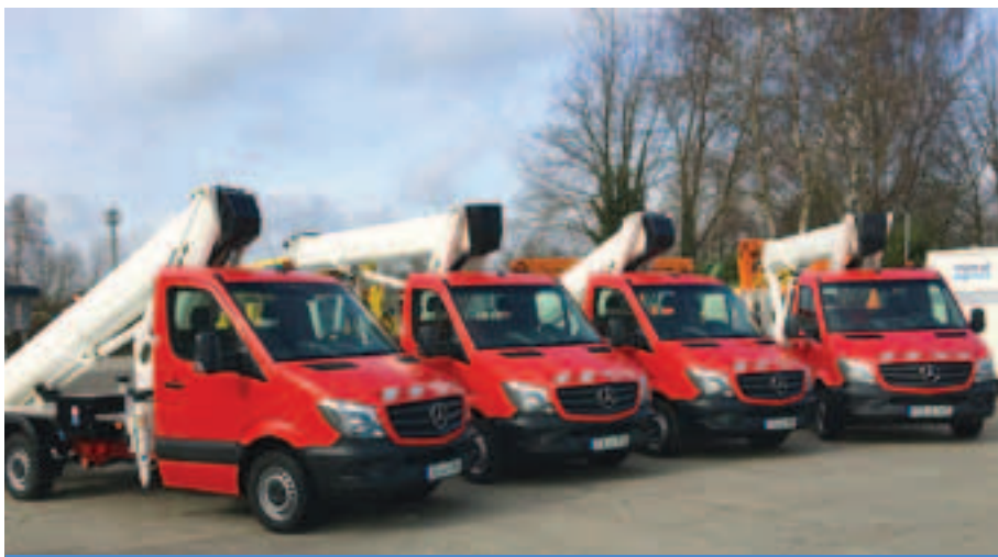
Ein Ruthmann-Quartett verrichtet nun seine Dienste bei Wemo-Tec. Es besteht aus einer TB 270, einer TB 290 und zwei TBR 250, aufgebaut auf 3,5-Tonner. Der Größte im Bunde, das 29-Meter-Gerät TB 290, hatte seinen ersten großen Auftritt sofort auf einer Trend-Messe in Fulda.
