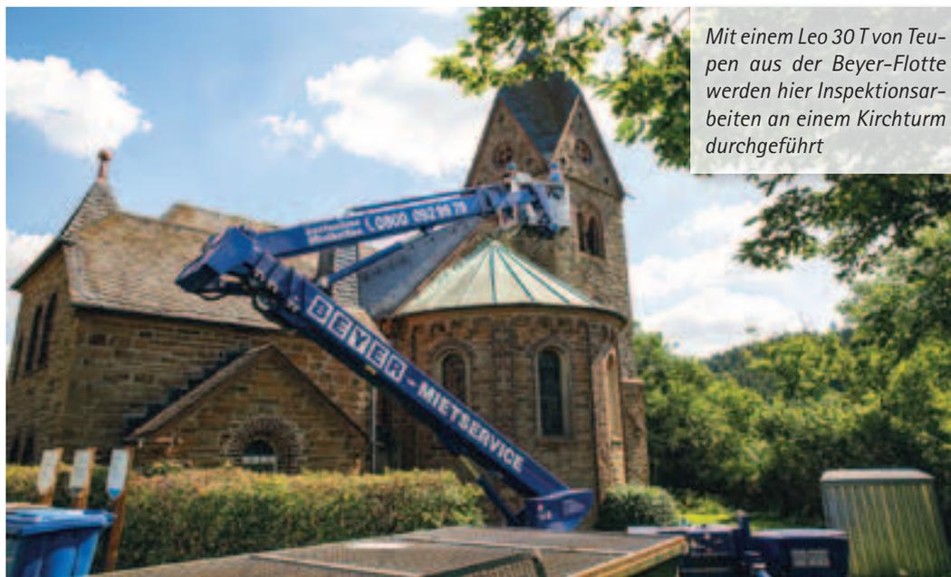
Mit einem Leo 30 T von Teupen aus der Beyer-Flotte werden hier Inspektionsarbeiten an einem Kirchturm durchgeführt
