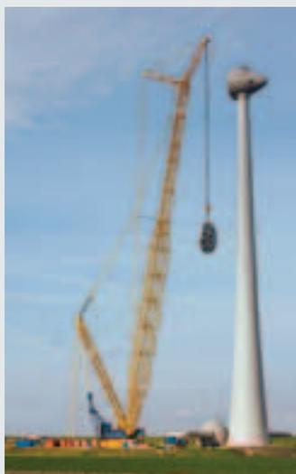
↑ Einen CC 8800-1 Gittermastraupenkran mit 1.600 Tonnen Tragkraft und Boom-Booster-Kit hat **M-Kran** aus Russland bei **Demag** bestellt. Der Kran hebt seine maximale Last auf einem Radius von zehn Metern und kommt auf eine maximale Rollenhöhe von 216 Metern. Mit dem Boom-Booster-Kit lässt sich die Kapazität stellenweise um bis zu 90 Prozent stei-
