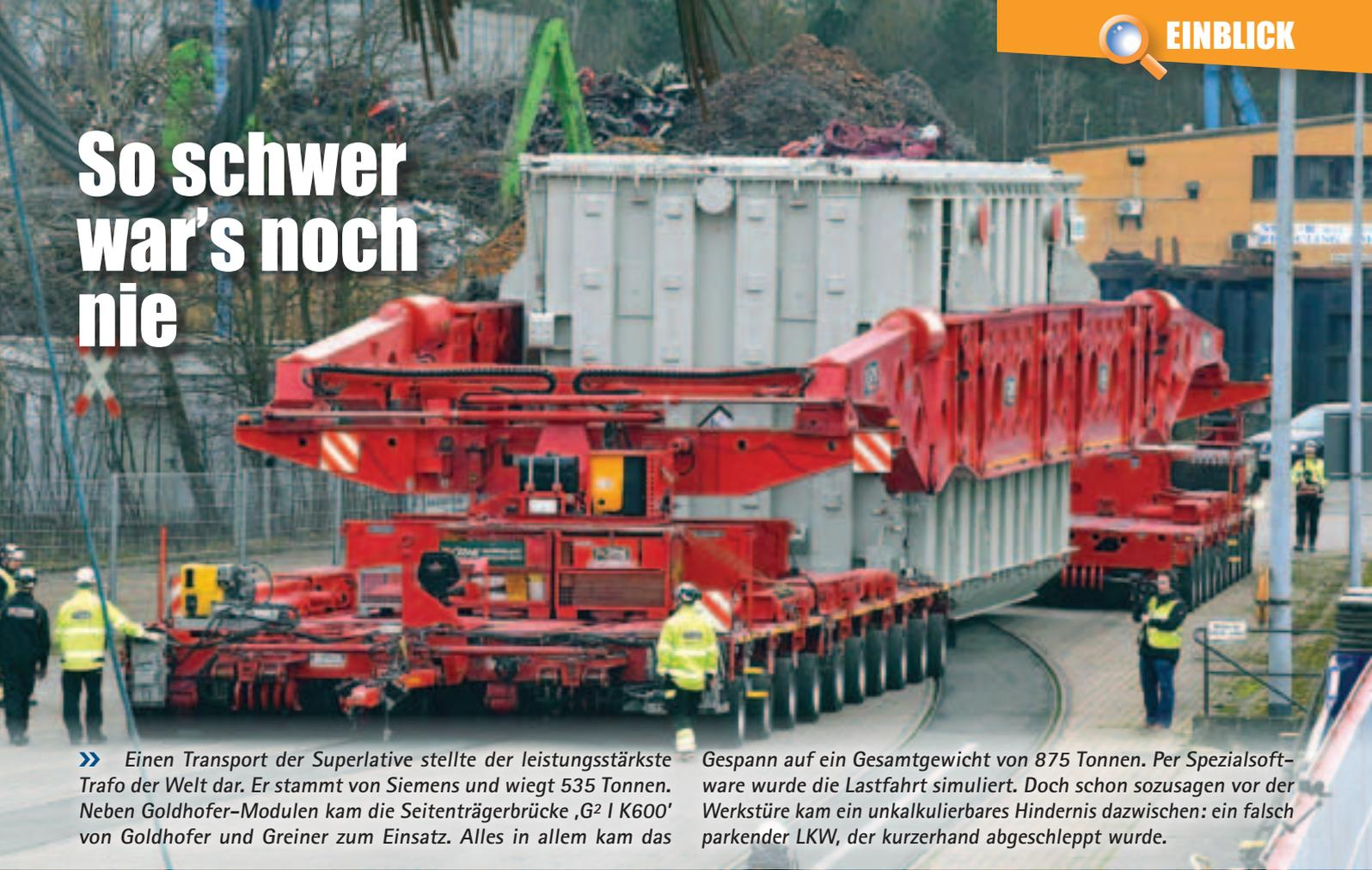
» Einen Transport der Superlative stellte der leistungsstärkste Trafo der Welt dar. Er stammt von Siemens und wiegt 535 Tonnen. Neben Goldhofer-Modulen kam die Seitenträgerbrücke ,G<sup>2</sup> I K600' von Goldhofer und Greiner zum Einsatz. Alles in allem kam das
