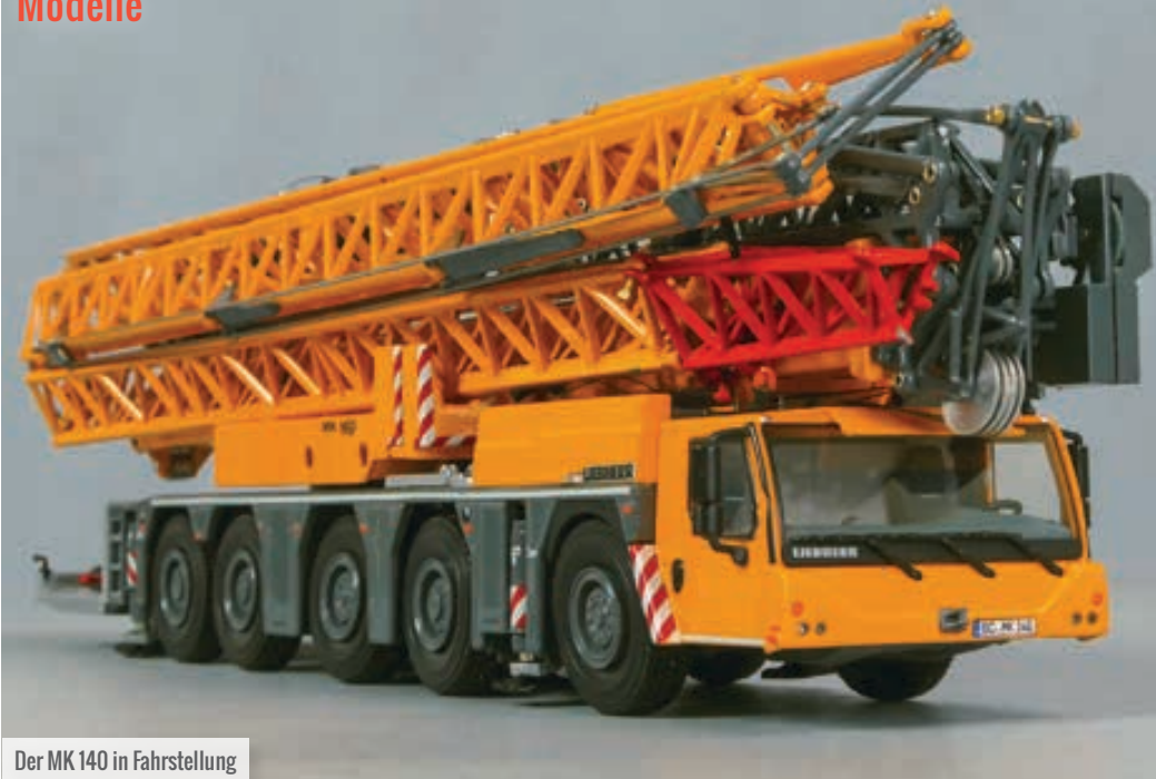
Die Krankabine kann mit einem Seil auf- und abbewegt werden
