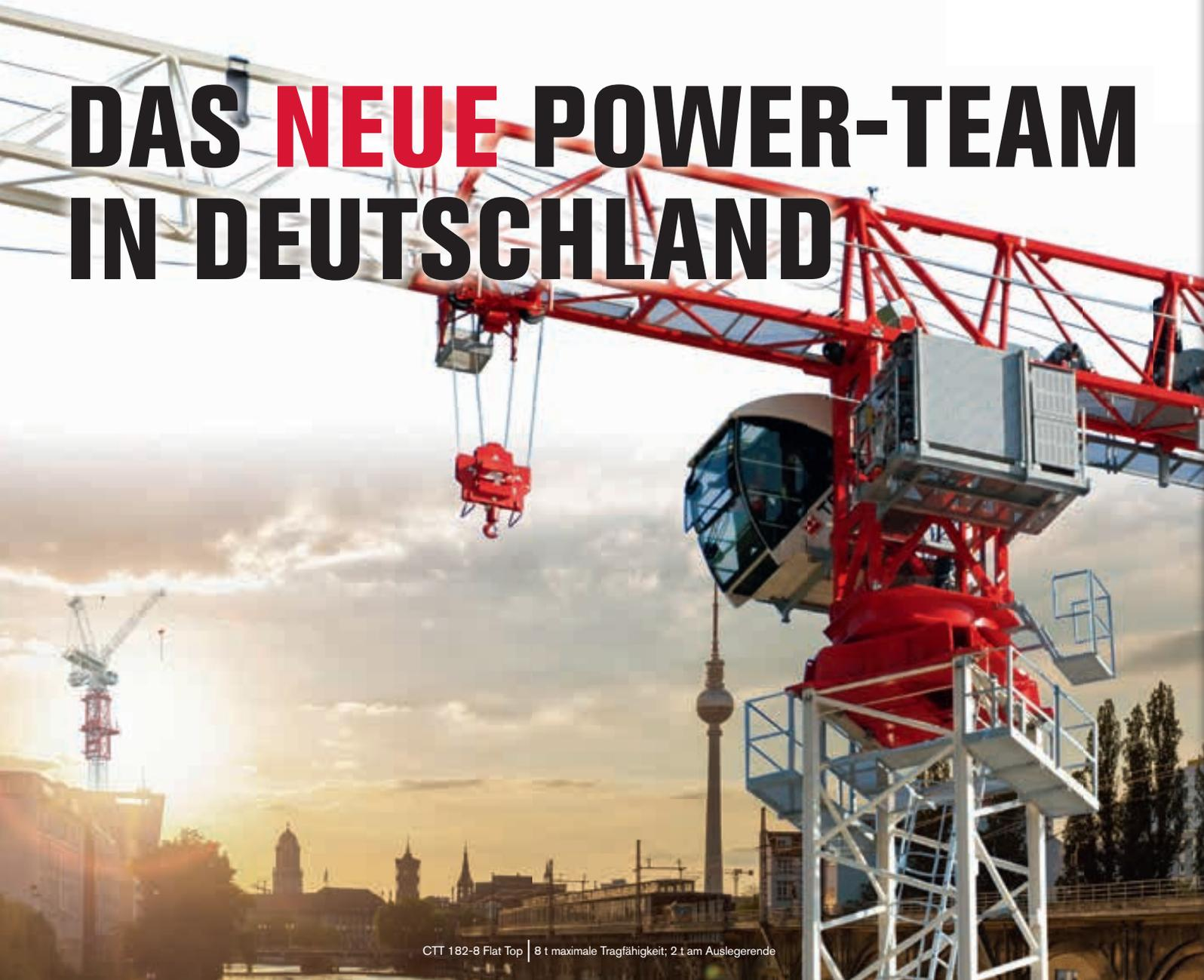
CTT 182-8 Flat Top | 8 t maximale Tragfähigkeit; 2 t am Auslegerende
