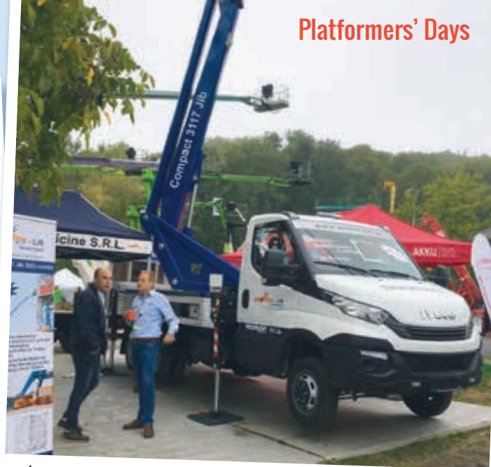
Weltpremiere für Comets 31-Meter-Bühne auf 3,5-Tonner (mit Anhänger), fahrbar mit BE-Führerschein
