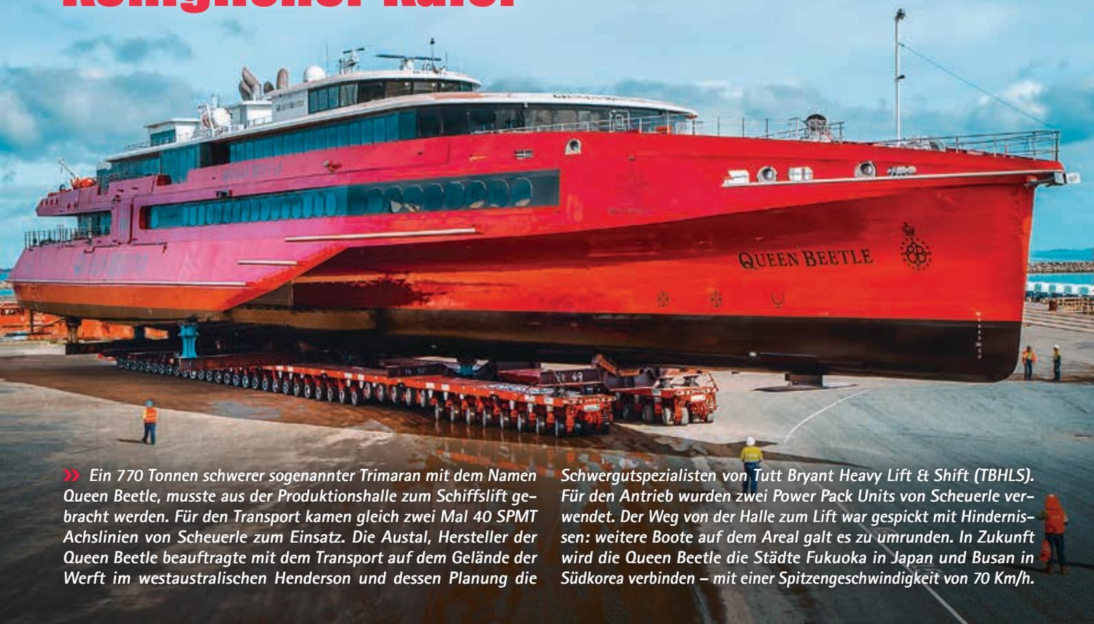
» Ein 770 Tonnen schwerer sogenannter Trimaran mit dem Namen Queen Beetle, musste aus der Produktionshalle zum Schiffsliift gebracht werden. Für den Transport kamen gleich zwei Mal 40 SPMT Achslinien von Scheuerle zum Einsatz. Die Austal, Hersteller der Queen Beetle beauftragte mit dem Transport auf dem Gelände der Werft im westaustralischen Henderson und dessen Planung die
