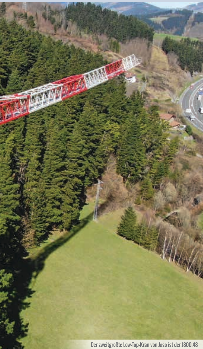
Weltweit größter Wipper mit 300 mt laut Jost Cranes: der JTL318.16
