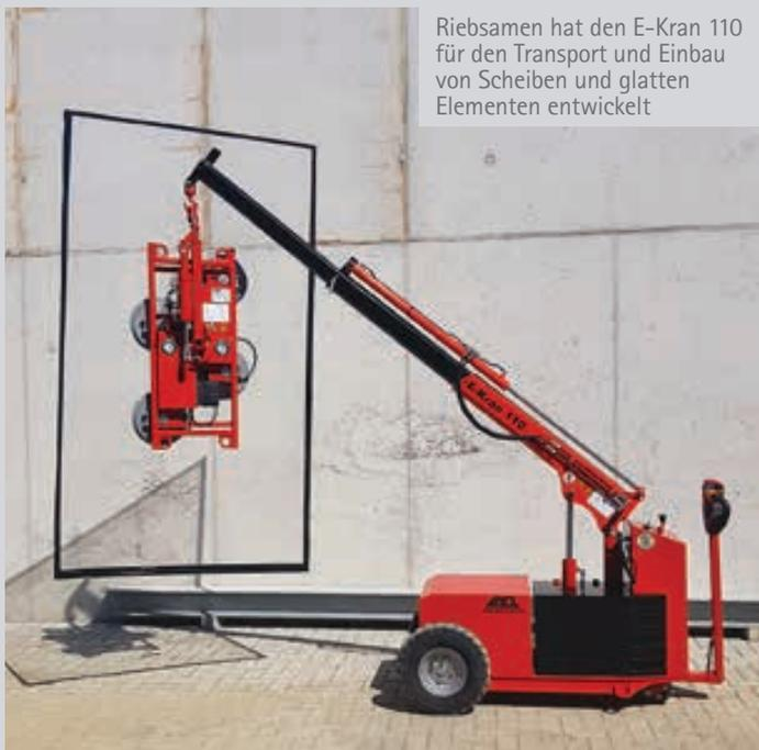
Riebsamen hat den E-Kran 110 für den Transport und Einbau von Scheiben und glatten Elementen entwickelt
