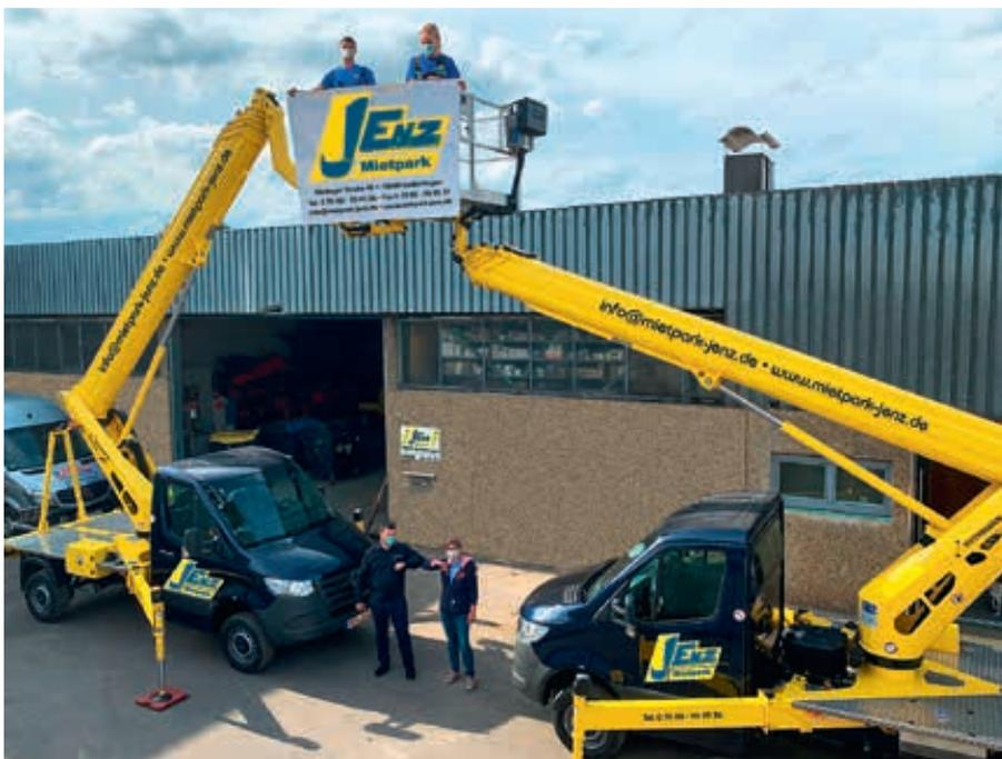
→ 56 Meter Arbeitshöhe bieten beide Neuzugänge der Firma Mietpark Jenz zusammen gerechnet: zum einen ein 26-Meter-„Steiger“ TBR 260, zum anderen ein TB 300 aus derselben Baureihe mit 30 Metern Arbeitshöhe.
