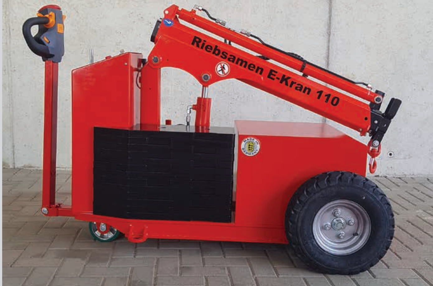
Abnehmbare Gegengewichte können das Eigengewicht des E-Kran 110 von Riebsamen auf 465 Kilogramm drücken
