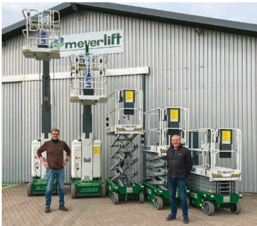
→ Gleich 17 Arbeitsbühnen hat Meyerlift aus Hohenwestedt in Schleswig-Holstein bei Haulotte bestellt. Zum Paket gehören vier Star 10 sowie 13 Elektroschere vom Typ Optimum 8. Firmeninhaber Olaf Meyer baut seine Flotte derzeit mit immer mehr elektrisch betriebenen Arbeitsbühnen aus.
