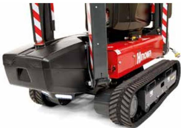
BEHÄLTER FÜR UNTERLEGPLATTEN
