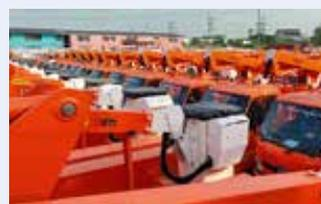
↑ Die thailändische Elektrizitätsbehörde PEA (*Provincial Electricity Authority*) hat 211 isolierte LKW-Arbeitsbühnen von **Palfinger ETI** über den lokalen Händler Hydroquip in Auftrag gegeben. Das im US-Werk von Palfinger ETI in Oklahoma gefertigte Modell ETC 37 IH bietet eine Arbeitshöhe von 12,8 Metern und eine Reichweite von 9,5 Metern
