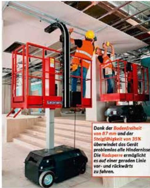
Dank der Bodenfreiheit von 87 mm und der Steigfähigkeit von 35% überwindet das Gerät problemlos alle Hindernisse. Die Radsperre ermöglicht es auf einer geraden Linie vor- und rückwärts zu fahren.
