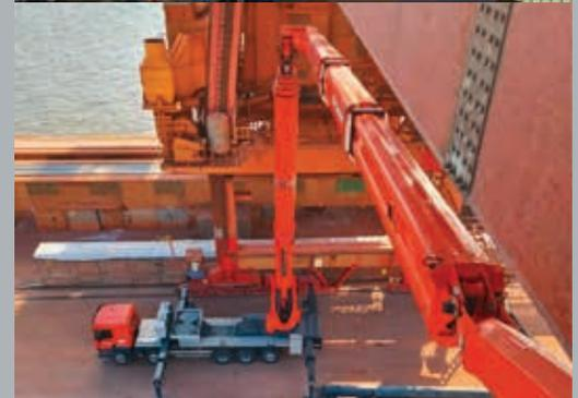
Wartungsarbeiten am Hafenkran mit der T 900 HF: Montage in 23 Meter Höhe bei einer seitlichen Reichweite von 34 Metern
