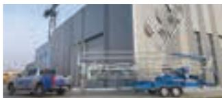
Vom spanischen Hersteller von Schnellmontage-Anhängerkrane wird aus der 3,5-Tonnen-Serie Midi LT in Karlsruhe vertreten sein. Am Stand seines neuen deutschen Generaldistributor Schwab wird der kompakte aufgestellt. Er erreicht bei Steilstellung eine Höhe von bis zu 20,3 Meter und kann bis zu 1.500 Kilogramm an den Haken nehmen. Aufgebaut ist der Kran in 15 Minuten.
