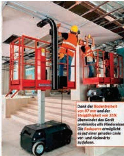
Dank der Bodentreifheit von 87 mm und der Steigfähigkeit von 35% überwindet das Gerät problemlos alle Hindernisse. Die Radsperre ermöglicht es auf einer geraden Linie vor- und rückwärts zu fahren.
