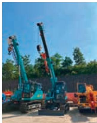
Als Neuheit ist das Model SWTC10, mit einer maximalen Tragkraft von zehn Tonnen und einer Hubhöhe von 26 Meter zu sehen. Der Raupenkran mit Pick& Carry Funktion kommt zusammen
