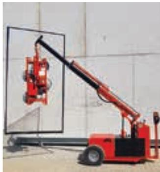
Der Anteil der Fenster, die mehr als 100 Kilogramm wiegen und damit händisch sehr schwer einzusetzen sind, wird ständig größer. Aus diesem Grund hat die Firma Maschinenbau Riebsamen eine Lösung gerade für dieses Problem entwickelt. Mit dem E-Kran 110 können Glasscheiben bis 500 Kilogramm im Gebäude ohne Muskelkraft gehoben und montiert werden.
