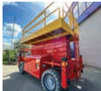
Der Schwerpunkt der Exponate liegt auf Scherenbühnen: Mit dabei das Modell S 175-12 E2WDS – mit neuester Motoren-generation. Die Schere hat eine Arbeitshöhe von 17,5 Metern. Mit der S 280-25 E4WDS ist eine breite, geländegängige Elektroschere ebenfalls am Stand. Die geräusch- und emissionsarme E-Schere kann laut Hersteller mit einer Dieselschere-bühne ganz klar mithalten.
