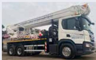
↑ Das australische Vermietunternehmen **JM Tower Hire** hat die erste 47-Meter-LKW-Arbeitsbühne des Typs **Bronto Skylift** S47XR in Australien in Empfang genommen. Die LKW-Bühne verfügt über eine maximale Reichweite von 26 Meter mit 120 Kilogramm Korblast oder 20 Meter mit der maximalen Plattformkapazi-
