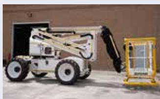
↑ Die US-Regierung hat bei der Vertriebs- und Servicefirma Alden Equipment 60 **Snorkel** A46JRT bestellt. Die 16-Meter-Gelenkteleskopbühne hat eine Reichweite von 7,35 Metern bei einer Übergriffhöhe von etwa acht Metern. Zu den Sonderausstattungen gehören eine neue duale Tragfähigkeit von 295 beziehungsweise 340 Kilogramm, überarbeitete obere und untere Bedienpulte und ein extra breiter Aluminiumkorb von 1,82 Meter x 0,76 Meter mit Saloonüren und griffigem Bodenbelag.
