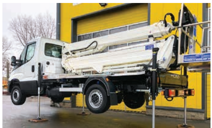
Cela DT-37: 450 Kilo Korblast bei 37 Meter Arbeitshöhe – auf 7,49 Tonnen
