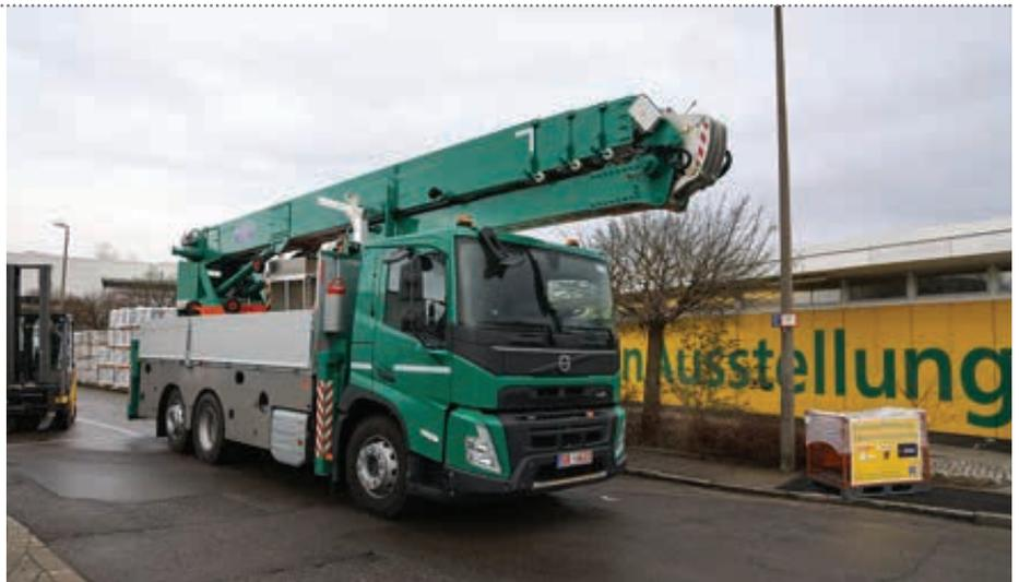
gestell auf drei Achsen unter. Dies sei in Verbindung mit der Kranleistung des K950 am Markt einzigartig, so das Unternehmen. Die seitliche Reichweite mit 1.000 Kilogramm am Haken liegt bei 28 Metern, während die maxi-
