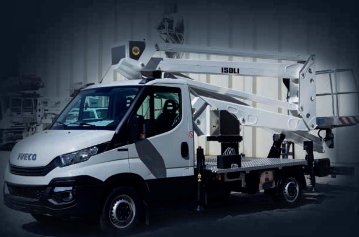
ISOLI PNT 215HE3 – Gelenk-Teleskop auf IVECO Fahrgestell
