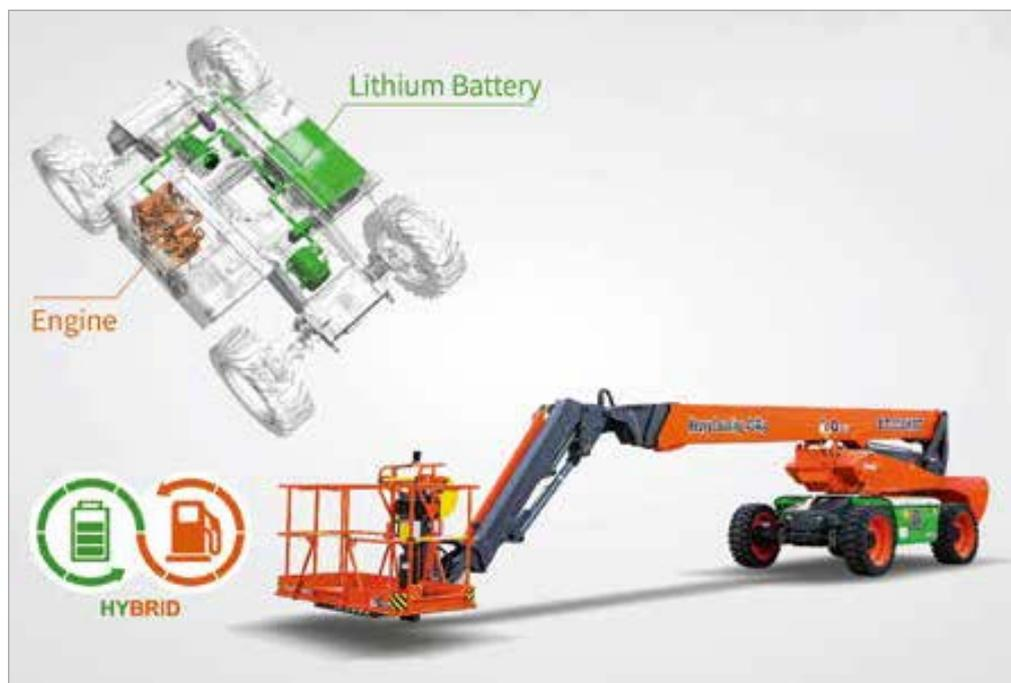
triebsarten: den manuellen Modus, bei dem der Benutzer zwischen dem rein elektrischen Betrieb der Arbeitsbühne und dem Betrieb mit laufendem Motor wählen kann, sodass der Akkupack voll geladen bleibt. Oder im Automatik-
