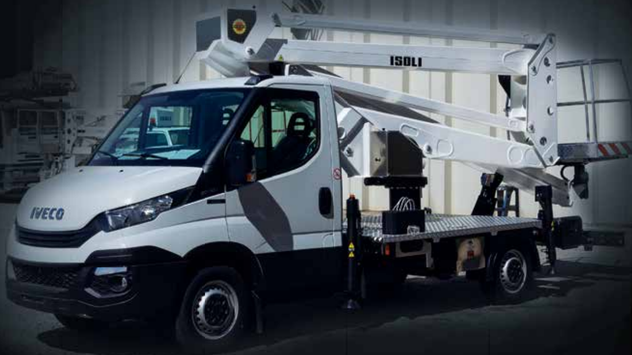
ISOLI PNT 215HE3 – Gelenk-Teleskop auf IVECO Fahrgestell
