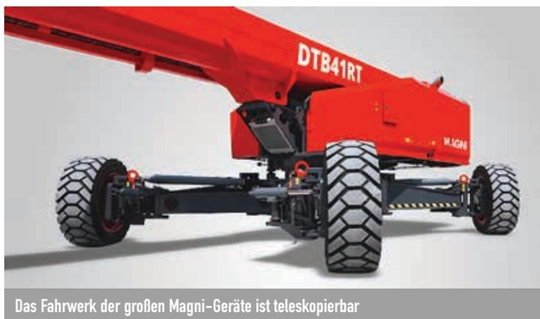
Das Fahrwerk der großen Magni-Geräte ist teleskopierbar
