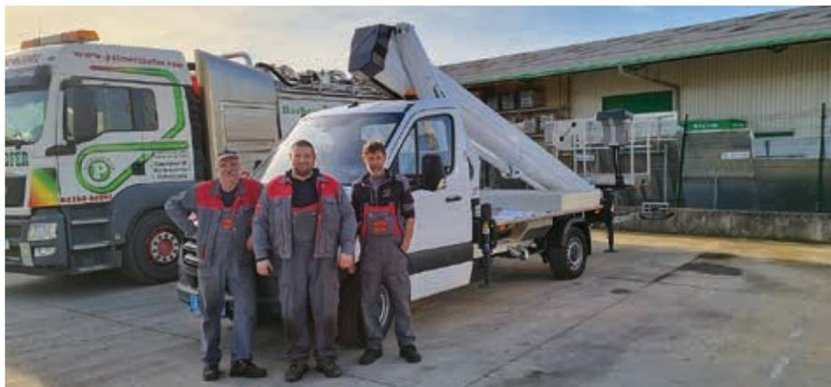
← Die Herbert Palmetzhofer GmbH, tätig im Bereich Entsorgung, Bau und Reinigung, erweitert um einen „Steiger“ TB 290 Pro. Das Ruthmann-Gerät bietet 29 Meter Arbeitshöhe, 17,40 Meter Reichweite und 250 Kilogramm Korblast auf einem 3,5-Tonnen-Chassis.
