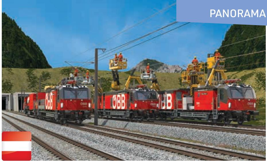
zialisierten – Hubarbeitsbühnen PA 240 & PA 1002 und Fahrdrattdrucker PFD 99, welche wir auf die innovativen Anforderungen der ÖBB adaptierten. Für die zunehmend anspruchsvolleren Anwendungen haben wir auch einen neuen Eisenbahnkran mit mehr Hubkapazität
