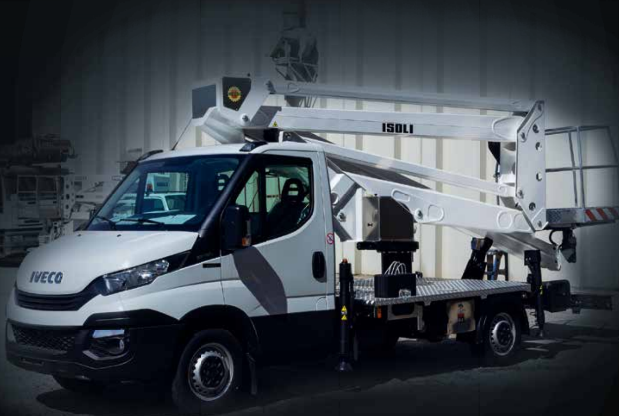
ISOLI PNT 215HE3 – Gelenk-Teleskop auf IVECO Fahrgestell
