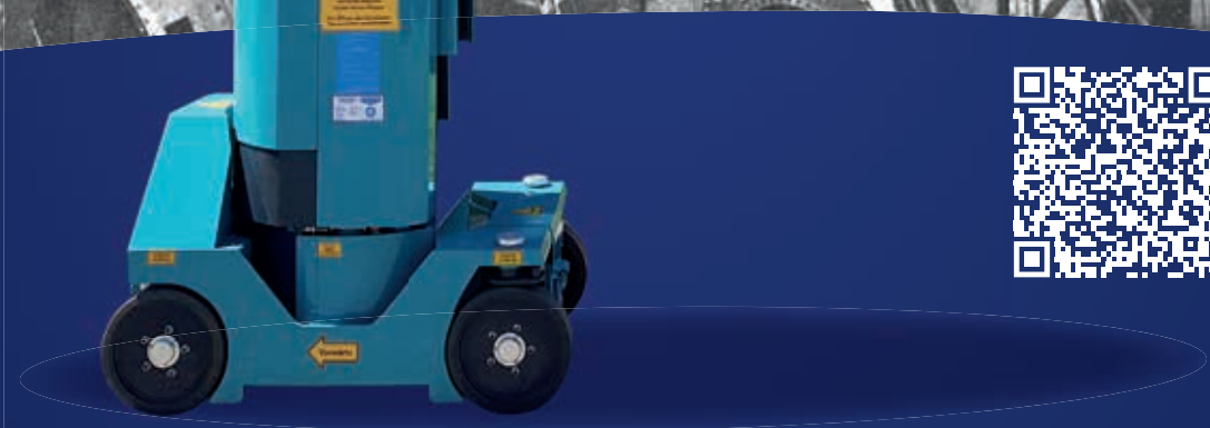
HELIX 1004XL mit 300 kg Traglast bei 4 m Reichweite
