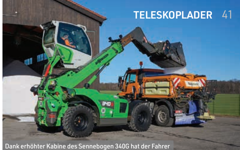
Dank erhöhter Kabine des Sennebogen 340G hat der Fahrer beim Schütten des Salzes Sicht in den LKW
