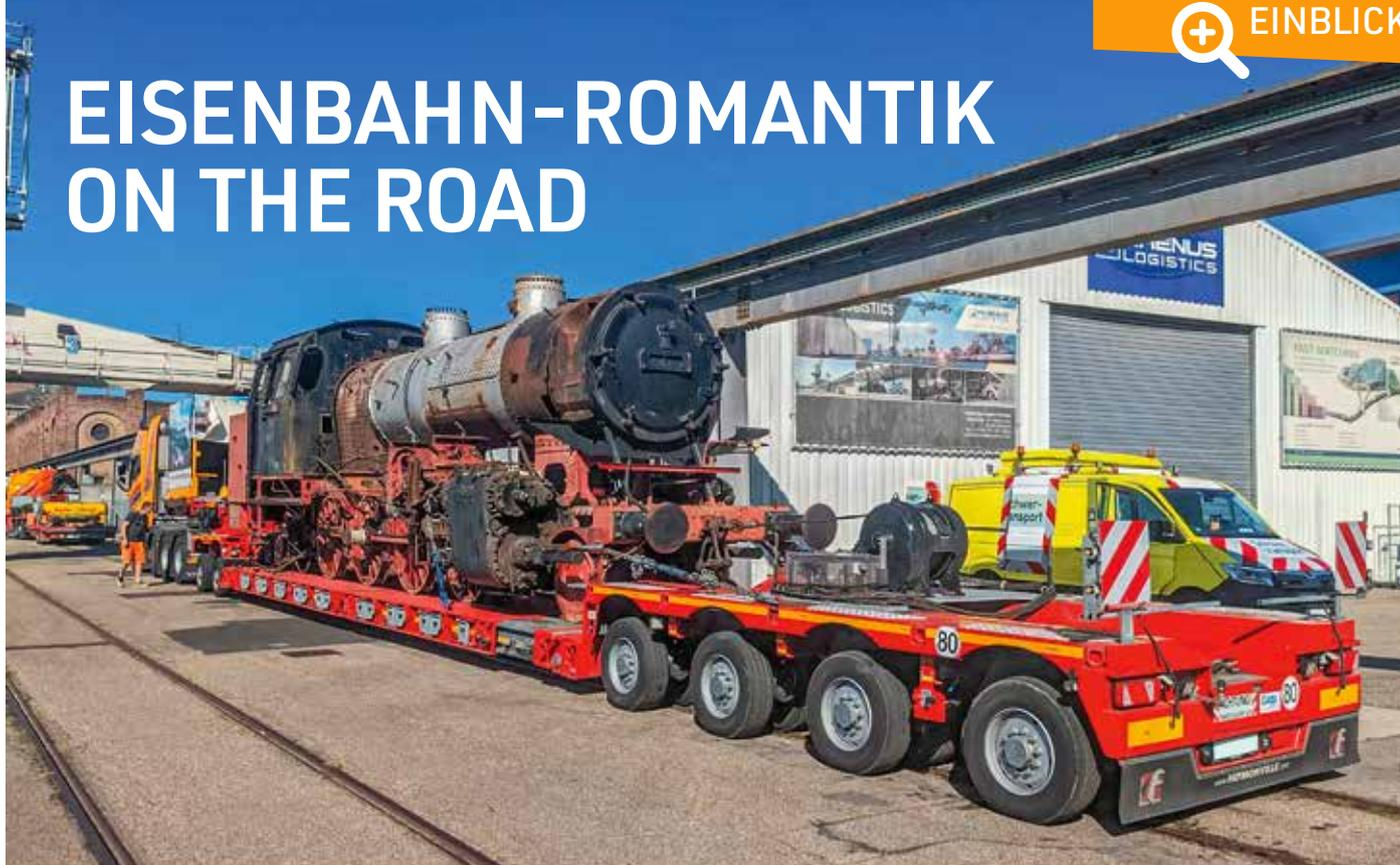
→ Nicht nur im Miniaturformat, sondern auch im realen Ausmaß erzeugen Lokomotiven oftmals eine besondere Anziehungskraft. Die Ulmer Eisenbahnfreunde sicherten sich eine Lokomotive vom Typ BR 86 346, welche bei der Deutschen Bahn im Jahr 1974 ausgemustert wurde. Knapp 50 Jahre später muss das geschichtsträchtige Gerät, das 60 Tonnen wiegt, per Straße vom Karlsruher Hafen nach Ettlingen transportiert werden.
