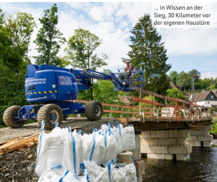
Die JLG 510AJ bietet knapp 18 Meter Arbeitshöhe und über 9 Meter Reichweite
