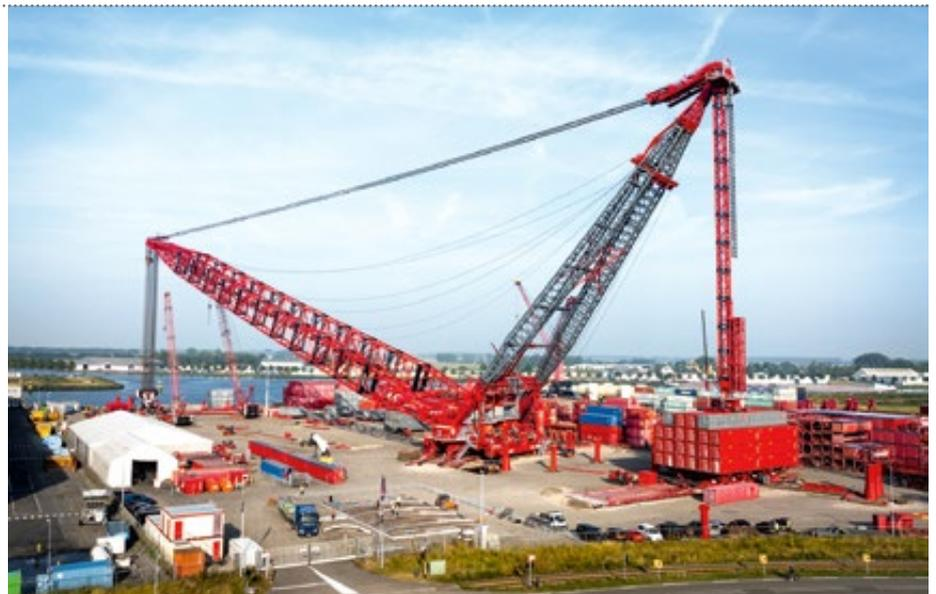
tiert sich an Containermaßen, wie es heißt, um den Einsatz beziehungsweise Transport zu erleichtern. Darüber hinaus kann der Kran vollständig mit Strom aus Batterien oder aus dem Netz versorgt werden, sodass die Kunden die CO<sub>2</sub>-Belastung ihrer Projekte erheblich
