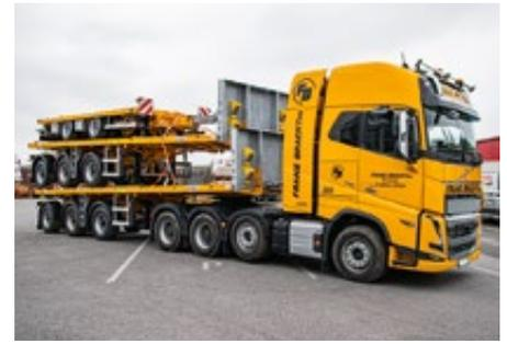
von 37.470 Kilogramm. Die beiden an Bracht ausgelieferten Ballastauflieger MAX410 sind für den Transport von Krangewicht und -komponenten. Er kann Nutzlasten bis zu 45 Tonnen mit sich führen. ■
