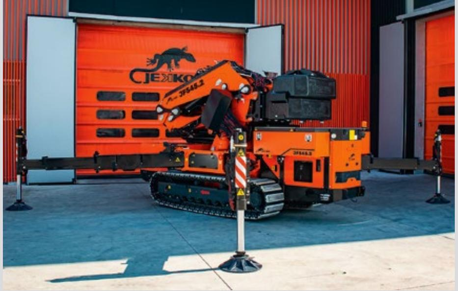
Daneben wurde das hydraulische System der Abstützungen überarbeitet. Der Kran lässt sich nun noch besser positionieren. Dazu wurde ein spezieller elektrischer Kühler für das Hydrauliköl eingebaut, um eine optimale Öltemperatur aufrechtzuerhalten, was die Leistung und Zuverlässigkeit des Systems erhöht. Der Kran ist mit einem neuen Diesel-
