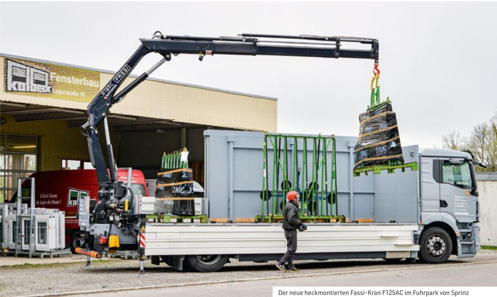
Der neue heckmontierten Fassi-Kran F125AC im Fuhrpark von Sprinz
