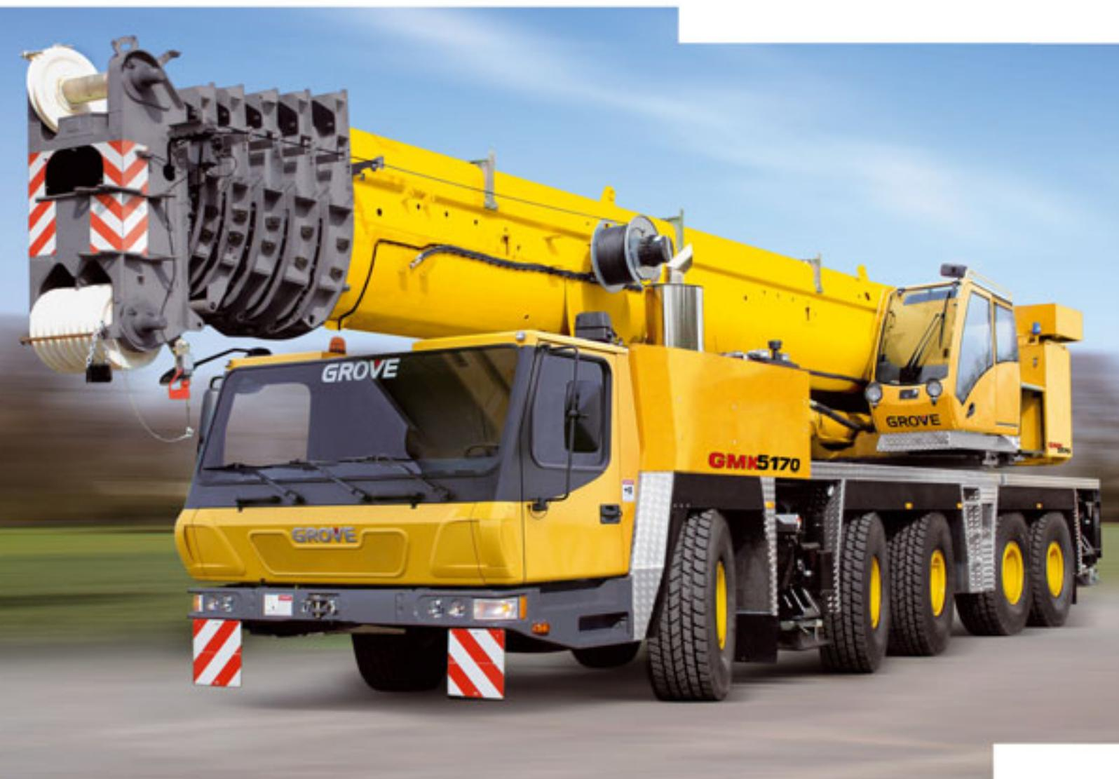
Der neue Grove 5170 verfügt über einen sechsteiligen TWIN-LOCK-Ausleger und hat eine maximale Tragkraft von 170 Tonnen. Beim Einsatz des optionalen Auslegers erreicht dieser Fünffachser-Mobilkran eine maximale Rollenhöhe von 101 m.
