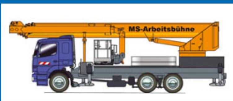
Der Arbeitsbühnenvermieter Schmid GmbH & Co. KG aus Esslingen hat sich für einen Ruthmann „Steiger“ T 580 entschieden. Ab Frühjahr 2009 steht den Kunden von Manfred Schmid damit eine LKW-Bühne zur Verfügung, die mit 58 Metern Arbeitshöhe und 40 Metern Reichweite glänzt. Auf einem Standard-3-Achs-Chassis wohlgemerkt.
