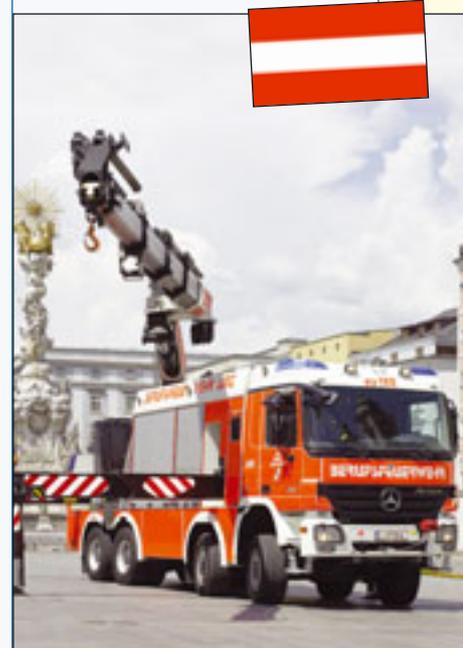
Ein schweres Rüstfahrzeug von Rosenbauer hat die Berufsfeuerwehr Linz in Empfang genommen. Der Vierachs-Actros verfügt über einen Bergekran von Palfinger, Typ PALFINGER PK 60002 E mit sechs hydraulischen Ausschüben. Dessen maximale Reichweite liegt bei 16 Metern. 2,5 Tonnen Hubkraft hat die Kranseilwinde.
