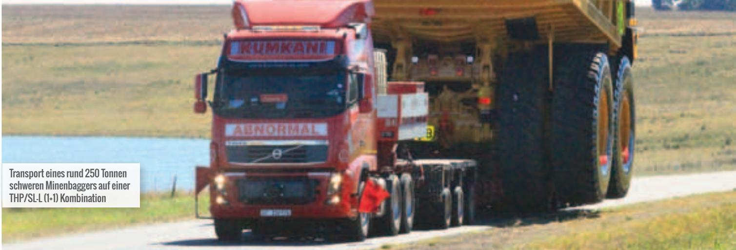
Transport eines rund 250 Tonnen schweren Minenbaggers auf einer THP/SL-L (1-1) Kombination
