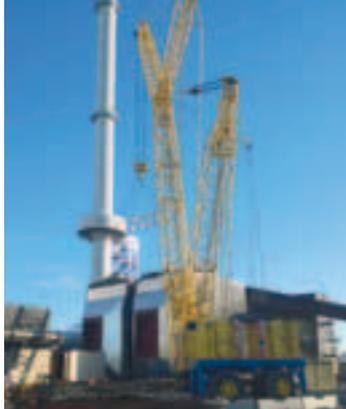
Auslegersegmenten, baute den 42 Meter langen Hauptausleger an und fügte einen 30-Meter-Wippausleger hinzu, um die erforderliche Hakenhöhe von 65 Metern zu erreichen. Aufgelegt wurden 435 Tonnen Ballast: 160 Tonnen Gegengewicht und weitere 275 Tonnen für die Superlift-Traverse. Zweieinhalb Wochen lang waren die zwei Kranfahrer plus Einsatzleiter und Funkeinweiser damit beschäftigt, die acht Hübe mit dem CC 2800 durchzuführen. <<
