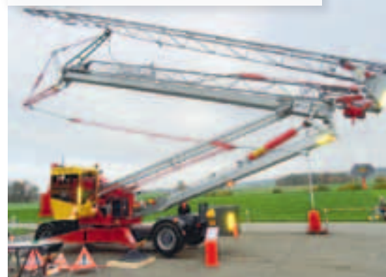
Der Kran wird in Fahrstellung gebracht, die Kabine ist noch in Arbeitsposition zur Seite geklappt, die Stützen noch ausgefahren
