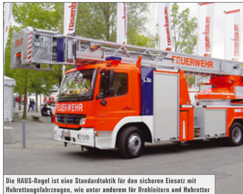
Zwei Meter negativer Überstand des drehenden Hubrettungssatzes müssen beim Einsatz mit berücksichtigt werden
