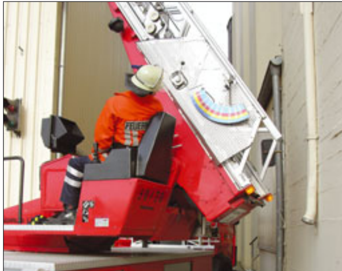
Zwei Meter negativer Überstand des drehenden Hubrettungssatzes müssen beim Einsatz mit berücksichtigt werden
