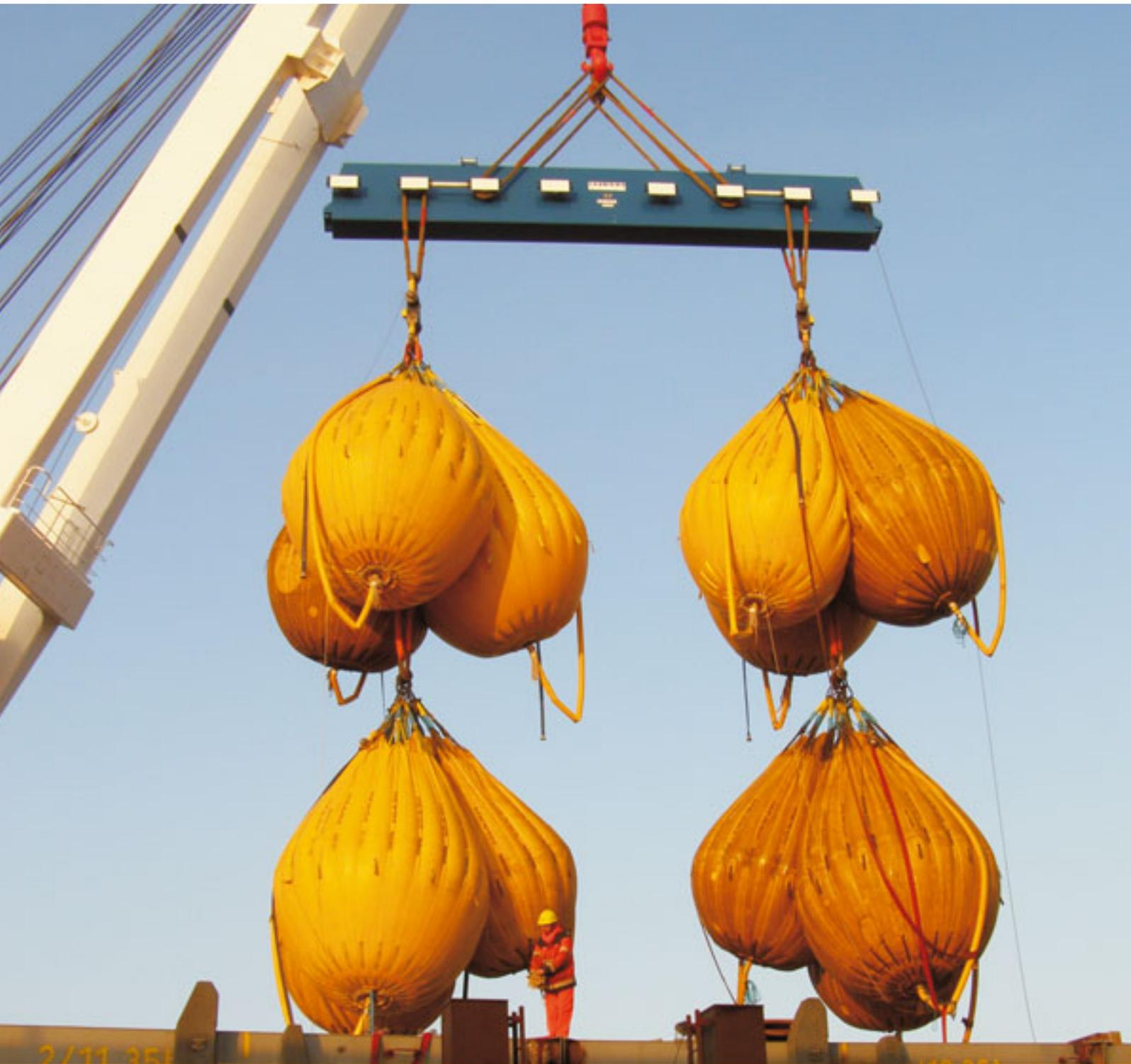
**Last- und Überlasttest für Krananlagen bis zu 1000 to.
