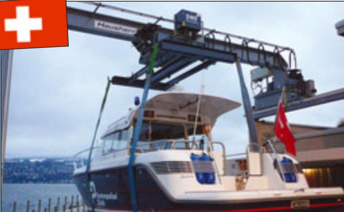
Ein neuer Hafenkran wassert die Einsatzboote der Seepolizei am Zürichsee, wo diese auf 89 Quadratkilometern für Sicherheit und Ordnung sorgt. Damit die Boote gewartet oder instand gesetzt werden können, hat der Schweizer Kranbauer Hausherr Kranservice aus Ottenbach die dazu benötigte Krananlage geliefert. Aufgabe: Eine bereits bestehende Anlage sollte durch das neue Werk
