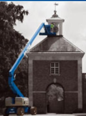
Die Genie® Z™-Gelenkteleskoparbeitsbühnen bieten erstklassige Arbeitsbereiche. Mit teleskopierbarem Korbarm, kontinuierlichem 360° Schwenkbereich des Oberwagens, aktiver Allradantrieb und Allradlenkung, gelangt der Anwender schnell und effizient zum Einsatzort - auch wenn der Weg dorthin über unebenes Gelände führt.
