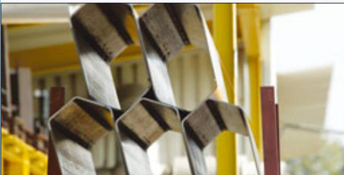
Die neue Sechskant-Fertigung im Palfinger-Werk Lengau ist nun angefahren. Sechskantrohre sind wesentlicher Bestandteil des Ausschubsystems am Kran. Die so genannten Schub- und Knickarme basieren auf Sechskantprofilen, welche aus hochfestem Stahl gefertigt werden. Die neue Sechskantrohr-Fertigung ist ein Bestandteil des 80 Millionen Euro starken Investitionsprogramms von Palfinger. Die bestehende Fertigung wird sowohl modernisiert als auch ausgebaut.
