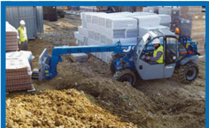
Genie hat ein ganzes Bündel von „optimierenden Konstruktionsverbesserungen“ bei den Teleskopladern 2506 und 3007 durchgeführt. Diese Verbesserungen beinhalten eine kompakte und komfortablere Kabine, verbesserte Tragfähigkeit bei maximaler Reichweite, ein neuer Motor, der den aktuellen Emissionsstandards entspricht, und einen leicht zugänglichen Motorraum für einen einfacheren und schnelleren Service.
