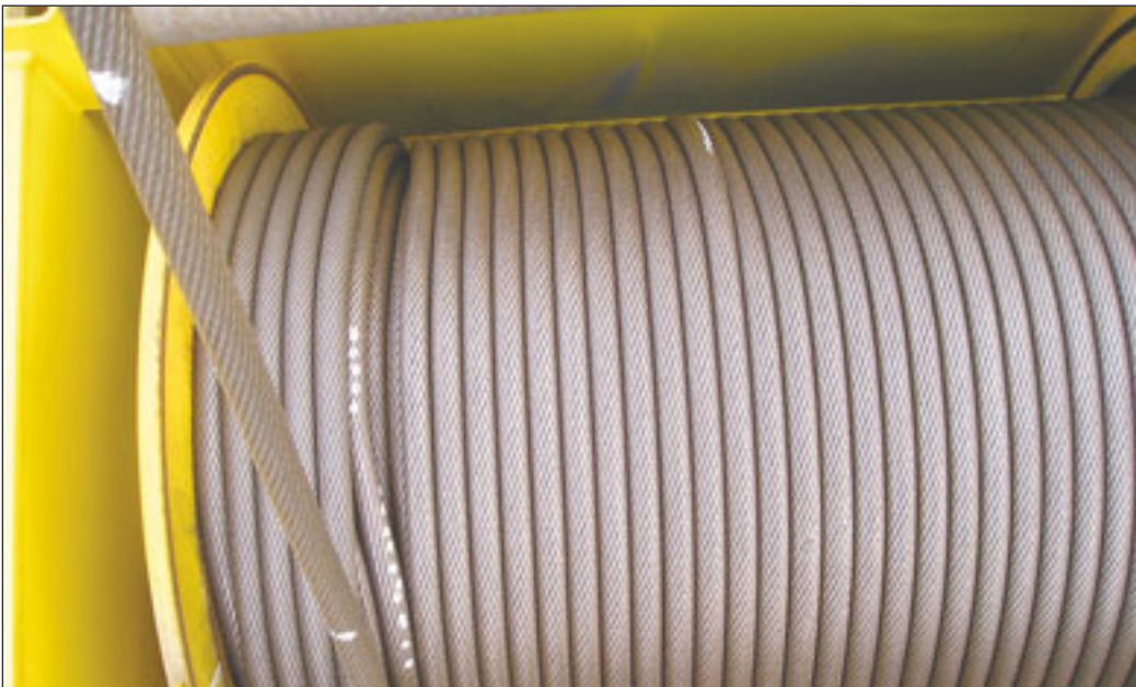
Der Anfang vom Ende: Eine typische Seilverletzung durch Mehrlagenwicklung auf der Trommel. Weitgehende Abhilfe schafft hier zum Beispiel ein oberflächenveredeltes, sprich: gehämmertes Seil.
