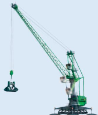
↑ Einen Hafemobilkran des Typs 9300 E wird **Sennebogen** Ende des Jahres an den türkischen Kunden **IDC Liman Isletmeleri** in den Hafen Izmir ausliefern. Mit 40 Meter Arbeitsradius bedient der Kran, der mit verstellbarer Kabine aufwarten kann, Schiffsgrößen bis zur Pana-
