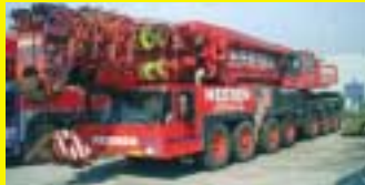
Demag AC 1200 1993 400 ton
