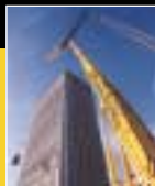
Liebherr LTM1400 Year 1998. Cap. 400 tonne. All Terrain.
